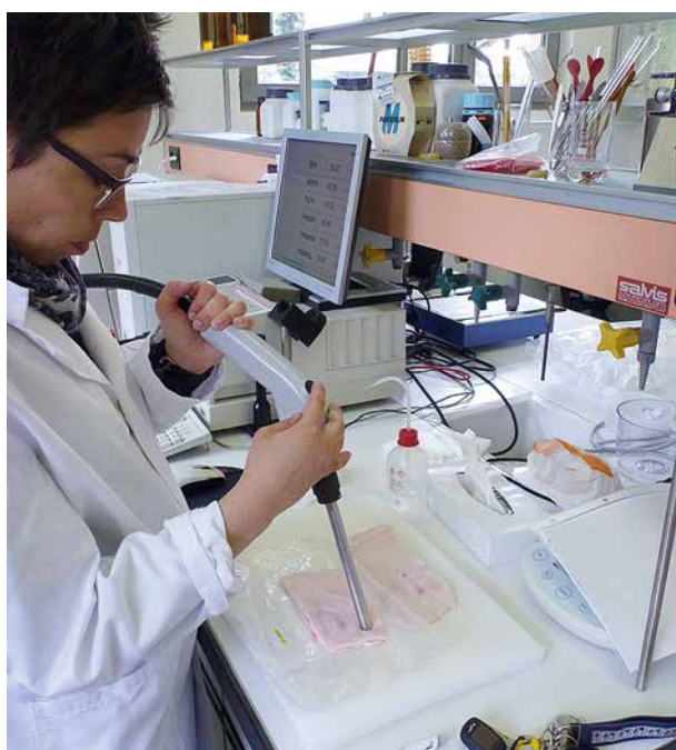
Abb. 4 | Auf der freigelegten subkutanen Fettschicht wird bei Zimmertemperatur mittels Lichtleiterpistole die Fettqualität bei Einzeltieren in kurzer Zeit bestimmt (Foto: Suisag)
