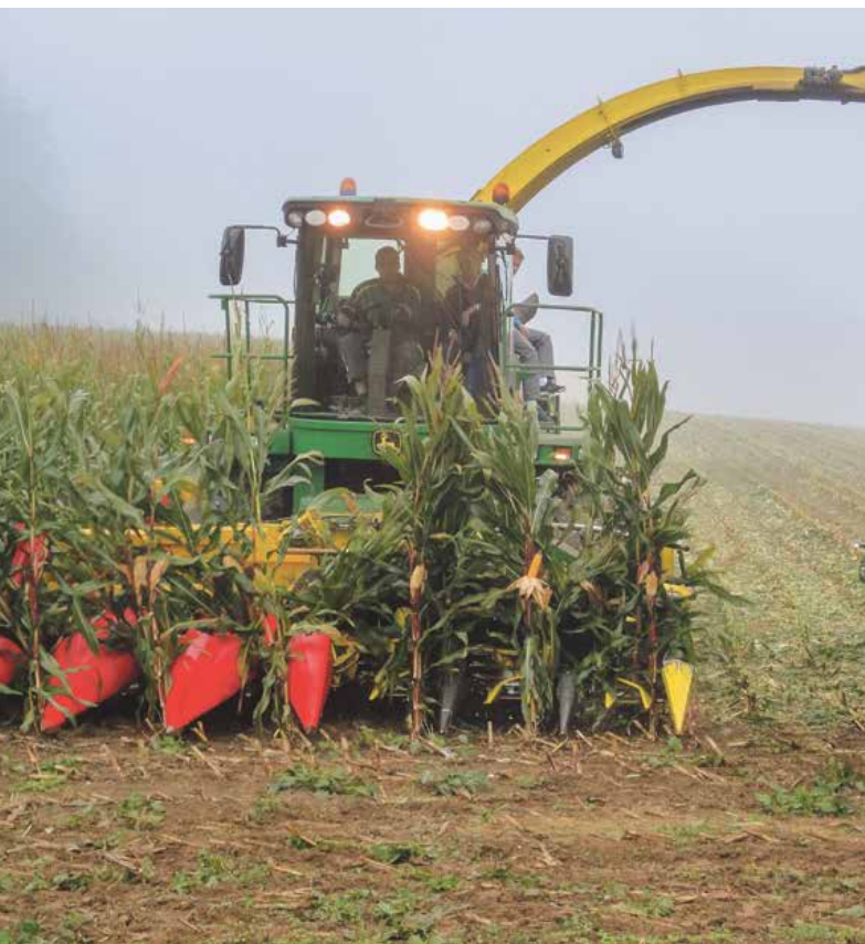
Abb. 1 | Selbstfahrender Feldhäcksler, ausgerüstet für die Ernte von 3 Reihen Ganzpflanzen und 3 Reihen Kolben. (Foto: Jean-Luc Oberson, Agroscope)
