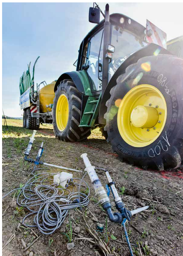
Bodendrucksensoren im Einsatz: Die HAFL entwickelt Lösungen um der Bodenverdichtung von Landwirtschaftsmaschinen entgegenzuwirken. (Foto: Marcel Kaufmann)
