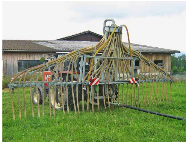
Abb. 5 | Schleppschlauchverteiler zum Ausbringen der Gülle. (Foto: Maja Siegenthaler)
