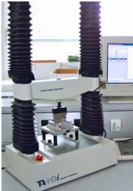
Abb. 1 | Der «Texture Analyzer TA-HDi», ausgestattet mit einer Warner-Bratzler Messzelle, welcher die Scherkraft gleichzeitig von 8 Proben mit einem Durchmesser von je 1,27 cm pro Scheibe misst.
