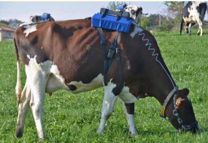
Abb. 1 | Milchkuh mit der Ausrüstung der Schwefelhexafluorid (SF 6 )-Marker-Technik zur kontinuierlichen Sammlung der Atemluft, in der anschliessend die Methankonzentration bestimmt wird.
