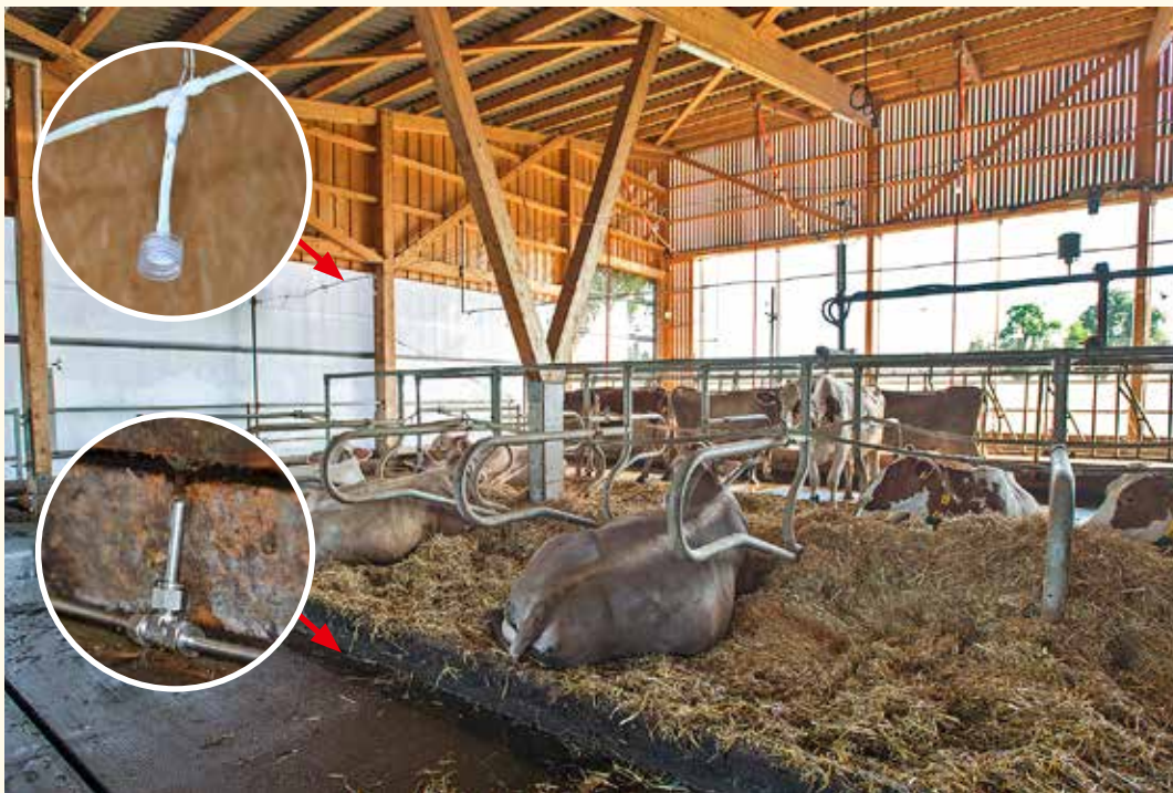
Im Emissionsversuchsstall in Tänikon zeigte sich, dass sich die beiden untersuchten Tracergase ähnlich verhalten wie \text{NH}_3 , \text{CH}_4 und \text{CO}_2 . Damit lassen sich Massnahmen zur Minderung von Ammoniak- und Treibhausgasemissionen messen. (Foto: Gabriela Brändle, Agroscope)
