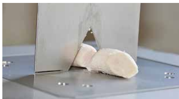
Abb. 8 | Bei länger gereiftem Fleisch braucht der Texture Analyzer weniger Kraft, um es zu zerschneiden, d.h. es ist zarter. (Foto: HAFL)
