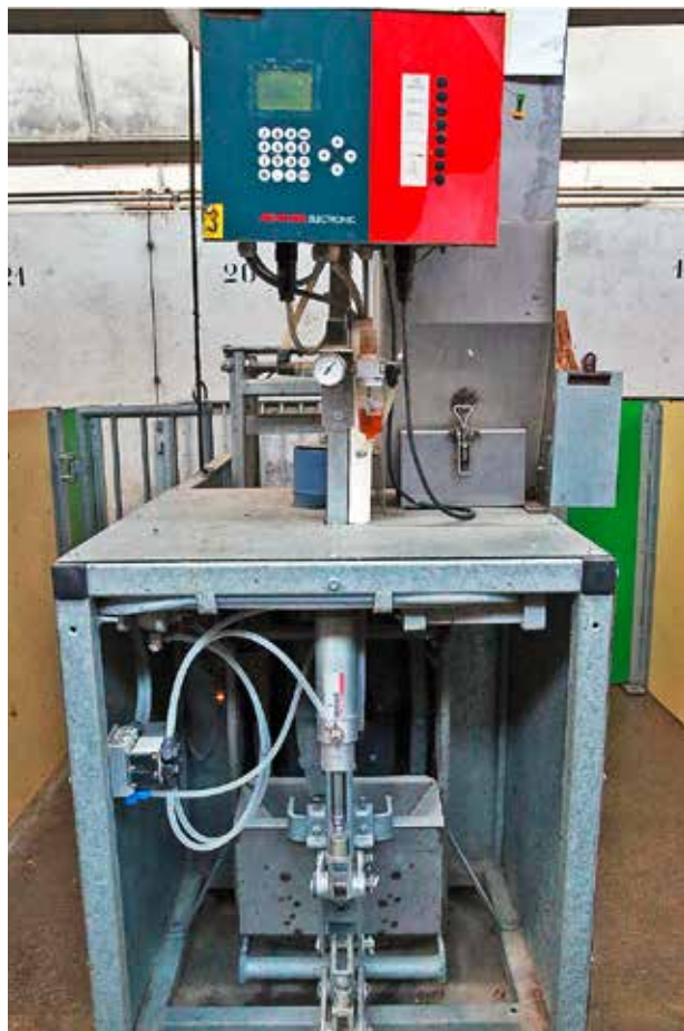
Abb. 1 | Eine der automatischen Fütterungsanlagen mit individuellem Schweineerkennungssystem, die in den Versuchen verwendet wurden. (Foto: Olivier Bloch, Agroscope)
