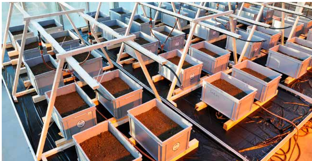
Abb. 3 | Neu angelegte Inkubationsversuche von bioabbaubaren Mulchfolien im Gewächshaus von Agroscope am Standort Reckenholz. Die Materialien werden in mehreren Böden der umliegenden Versuchsflächen über mehrere Jahre inkubiert und deren Rückstände periodisch quantifiziert. Als Bodenbedecker wird eine standortübliche Wiesenmischung angesät. (Foto: Franco Widmer, Agroscope)
