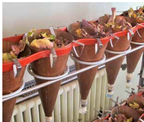
Figure 2 | Méthode de Berlese, type conique, pour l'extraction des larves de l'altise d'hiver du colza ( Psylliodes chrysocephala ).
