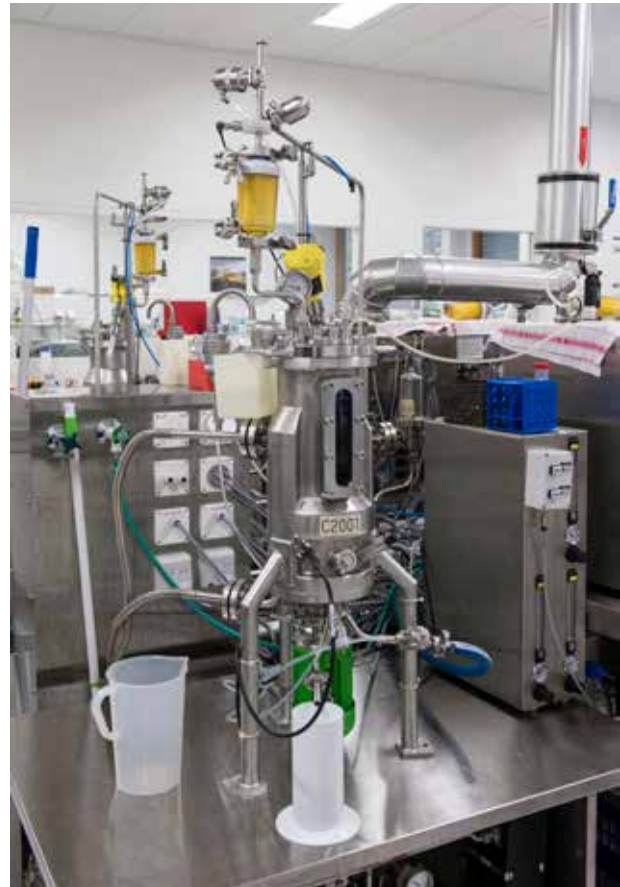
Abb. 3 | Bioreaktor für die experimentelle Züchtung der Herkunftsnachweiskulturen.
