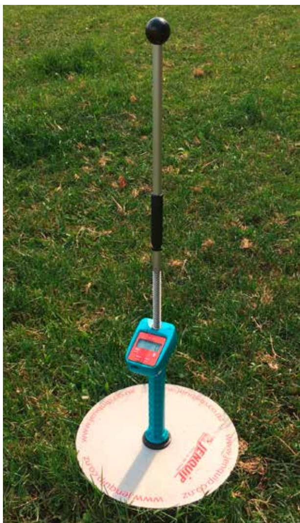
Abb. 1 | Der Platten-Herbometer ermittelt die komprimierte Wuchshöhe von Wiesen und Weiden. (Foto: Fredy Schori, Agroscope)
