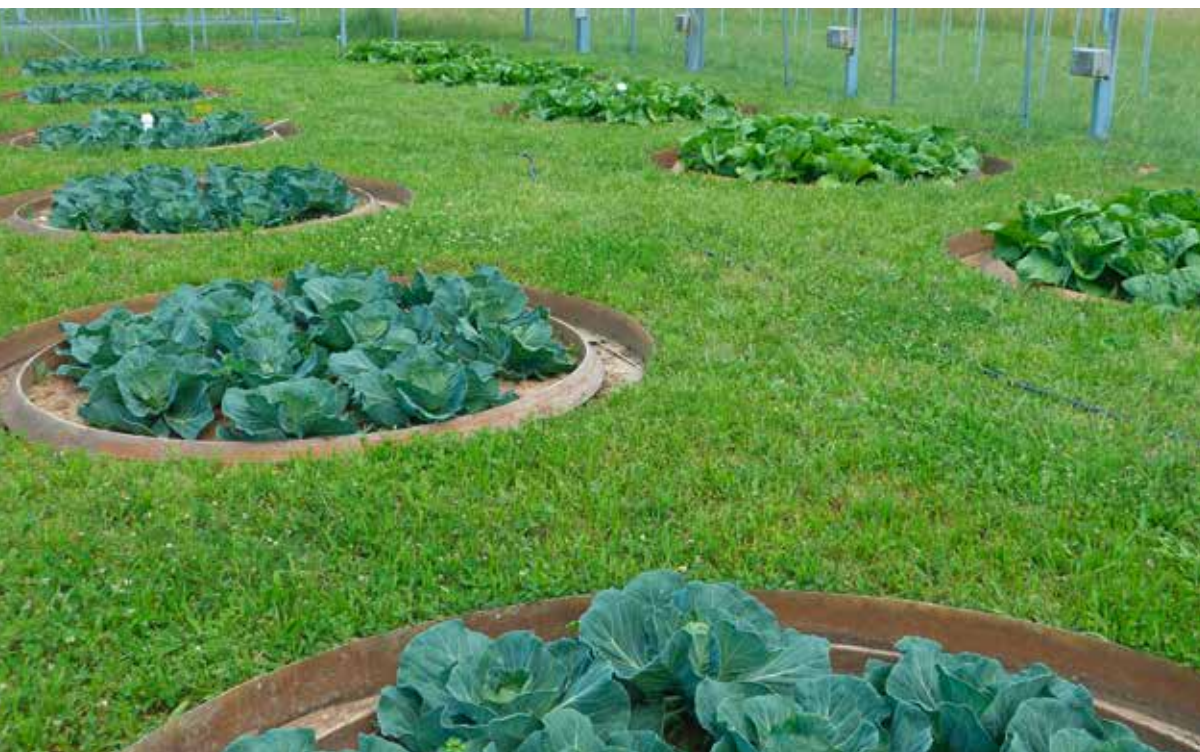
Mesure du lessivage des nitrates dans les cultures maraîchères à l'aide de lysimètres. (Photo: Ernst Spiess, Agroscope)
