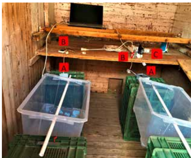
Abb. 2a | Plastik-Drehkisten zur standardisierten Staubmessung, A = Staubsensor, B = Kleinstcomputer, C = Mini-Computer. (Foto: Jan Kocher, HAFL)
