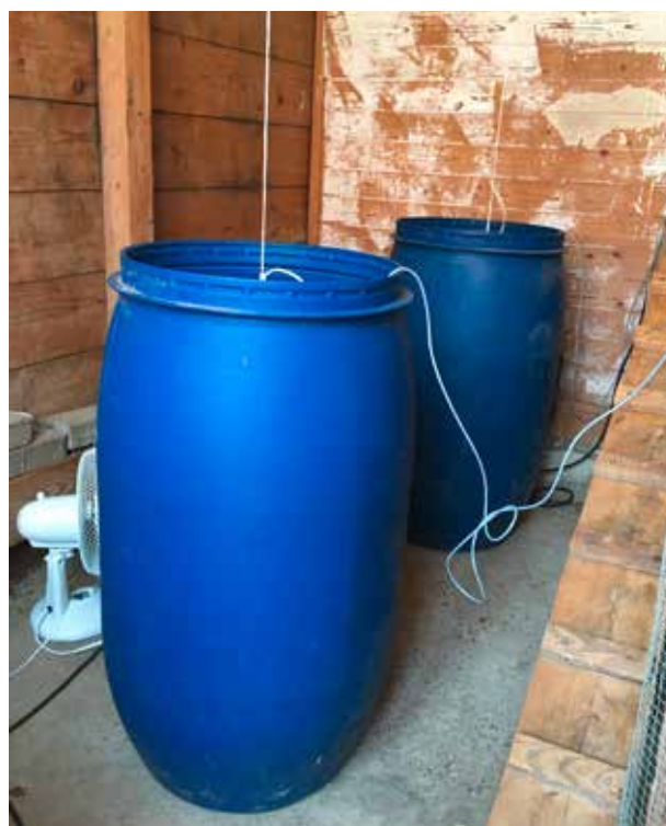
Abb. 3 | Kunststofffässer mit eingehängten Ammoniakensoren und Ventilator zur anschliessenden Raumumlüftung. (Foto: Jan Kocher, HAFL)
