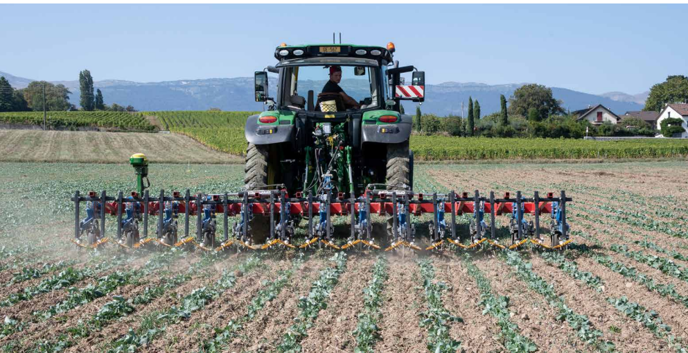
Mechanische Unkrautbekämpfung einer Rapskultur auf einer Versuchspartelle des Projekts PestiRed im September 2020. In Kombination mit anderen Unkrautbekämpfungsmassnahmen kann damit der Einsatz von Herbiziden reduziert werden (Foto: Carole Parodi, Agroscope).
