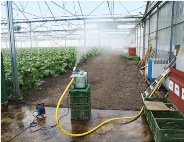
Figure 1 | Appareil de nébulisation à froid «PFALZTECHNIK». L'insecticide Pirimor (pirimicarbe) et le fongicide Switch (cyprodinil, fludioxonil) ont été appliqués, à raison de 0,8 kg pour 15 litres d'eau et 2 litres de bioaérosol pendant une heure dans une serre (0,87 hectare de surface au sol), sur des aubergines. L'appareil a été utilisé conformément aux recommandations du distributeur local, Hortiplus Sàrl.
