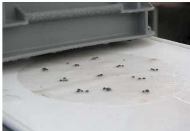
Figure 3 | Désinfection à la vapeur aérée de graines de basilic sur papier filtre, sur le tapis roulant de la machine d'ACW.
