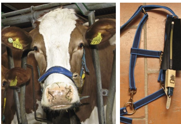
Figure 1 | Le set de mesure se compose d'un capteur de pression et d'un enregistreur de données (MSR145) placés dans une doublure et une poche sur la bride nasale du licol. (Photos: ART)
