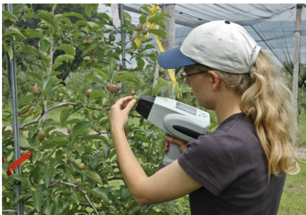
Figure 8 | Un appareil de spectrométrie proche infrarouge utilisable sur le terrain est testé ici au champ pour son aptitude à la détection anticipée des fruits qui tomberont à un stade précoce.
