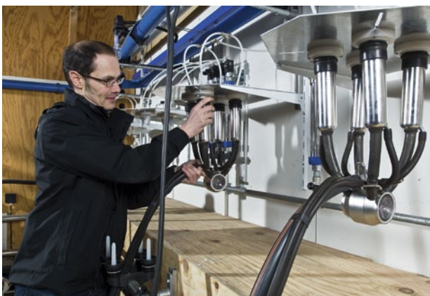
Figure 1 | Le projet «Optimisation de la production laitière» fait partie des programmes de recherche NutriScope et ProfitLait. Il associe des domaines de recherche de la technique aux domaines de la santé, du comportement et de la physiologie des animaux. La paroi de traite expérimentale d'ART, qui simule le procédé de traite, permet d'étudier un mode de production laitière respectueux des animaux et l'amélioration simultanée de la santé de la mamelle. (Photo: ART)
