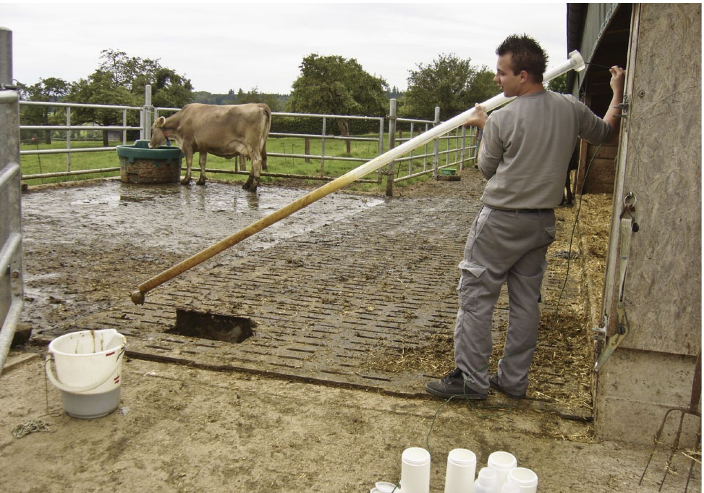
Figure 1 | Le lisier a été prélevé verticalement à l'aide d'une sonde en verre acrylique sur une exploitation. (Photo: ART)
