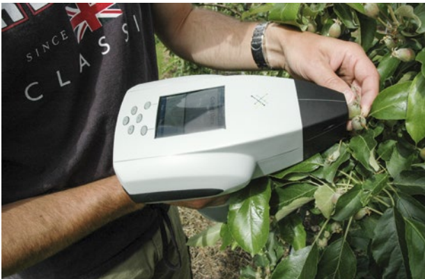
Figure 3 | Mesure des fruits au moyen du spectromètre proche infrarouge. (Photo: ACW)
