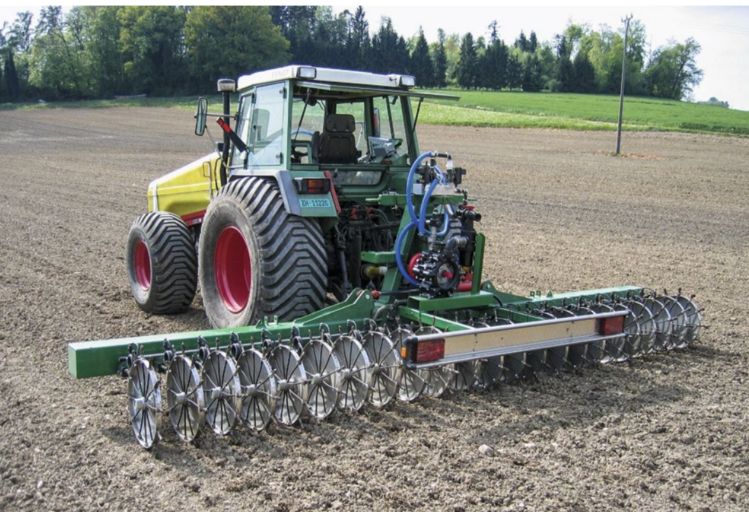
Application d'azote au moyen d'un engin équipé de roues d'injection en étoile. (Photo: Peter Briner)
