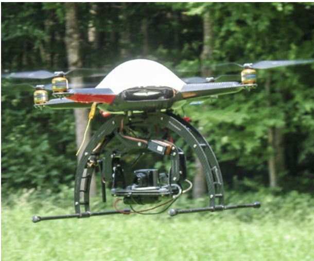
Figure 2 | Quadricoptère avec caméra thermique fixée sur une armature mobile en deux dimensions pour détecter les faons. (Photo: Nicole Berger)
