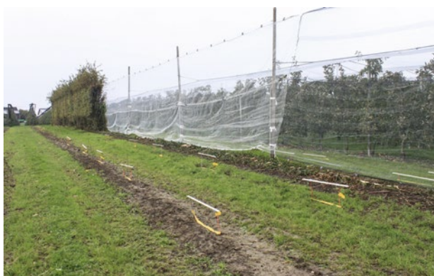
Figure 3a | Mesure des dépôts au moyen de bandelettes de papier filtre. On voit au premier rang la méthode de réduction de la dérive «filet en bordure de la parcelle», à l'arrière-plan la haie brise-vent.
