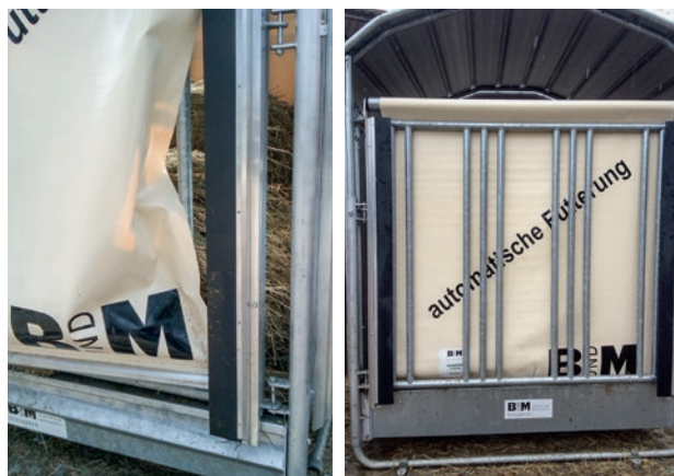
Figure 3 | Problèmes de fonctionnement du dispositif de fermeture/ouverture. (Photo: Agroscope)
