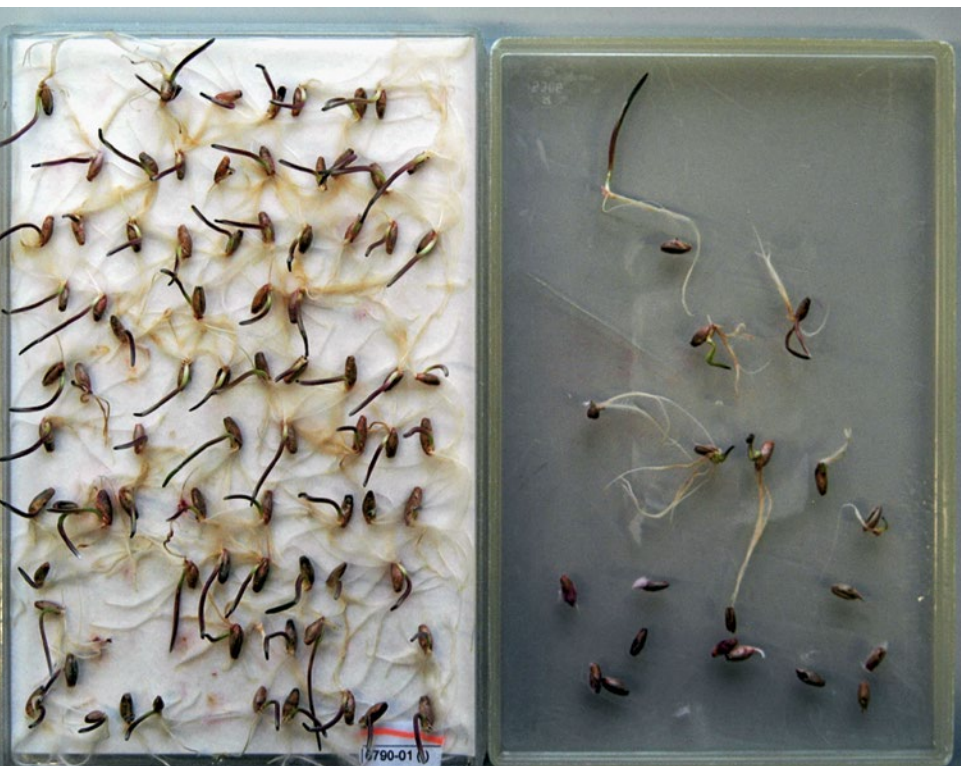
Germes de seigle normalement développés (à gauche) et anormalement développés (à droite) après huit jours sur du papier filtre. (Photo: Thomas Hebeisen, Agroscope)
