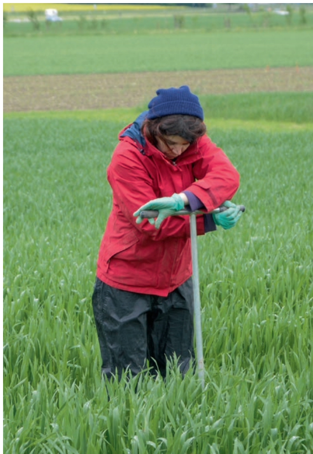
Figure 3 | Echantillonnage de sol avec une tarière dans un champ de blé à Tänikon (TG).
