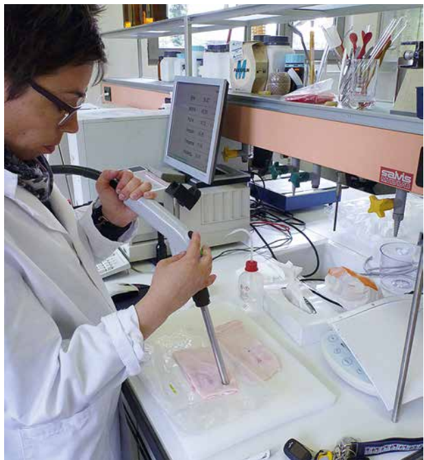
Figure 4 | Pour chaque animal, la qualité de la graisse est déterminée en peu de temps sur la couche de graisse sous-cutanée, à température ambiante, au moyen d'une sonde à fibre optique. (Photo: Suisag)
