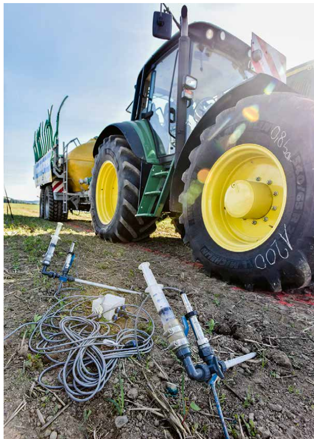
Des capteurs mesurent la pression dans le sol: la HAFL développe des moyens de contre la compaction des sols causée par les machines agricoles. (Photo: Marcel Kaufmann)
