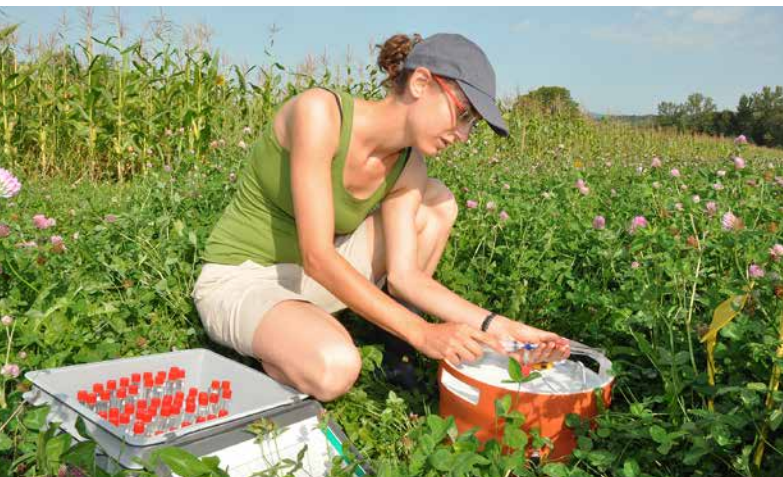
Mesure de gaz à effet de serre dans le cadre d'une étude du FiBL à Frick visant à déterminer l'influence du travail réduit du sol en agriculture biologique sur les émissions de protoxyde d'azote. (Photo: Thomas Alföldi, FiBL)
