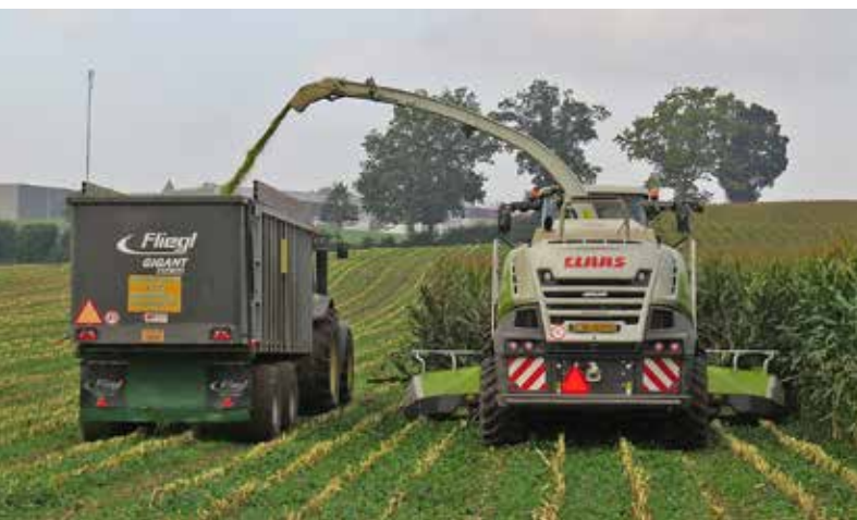
Récolte de l'ensilage de maïs plante entière à Agroscope, site de Posieux; shredlage récolté avec le système breveté par CLAAS. (Photo: Yves Arrigo, Agroscope)
