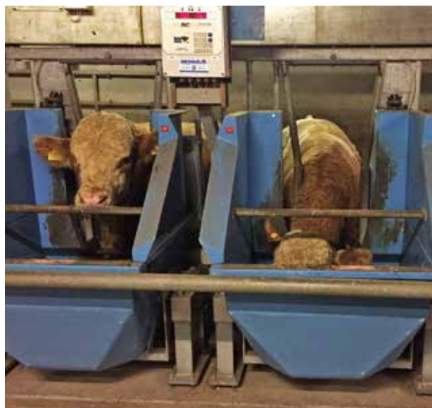
Figure 1 | Grâce au système électronique de crèches montées sur balance, l'ingestion journalière individuelle peut être mesurée automatiquement. (Photo: Isabelle Morel, Agroscope)
