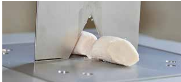
Figure 8 | L'analyseur de texture a besoin de moins de force pour couper la viande maturée plus longtemps, ce qui veut dire qu'elle est plus tendre. (Photo: HAFL)
