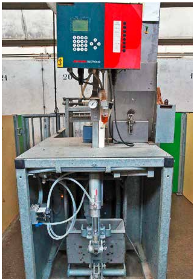
Figure 1 | L'un des distributeurs automatiques de concentrés dotés d'un dispositif d'identification individuelle des porcs utilisés dans les essais. (Photo: Olivier Bloch, Agroscope)
