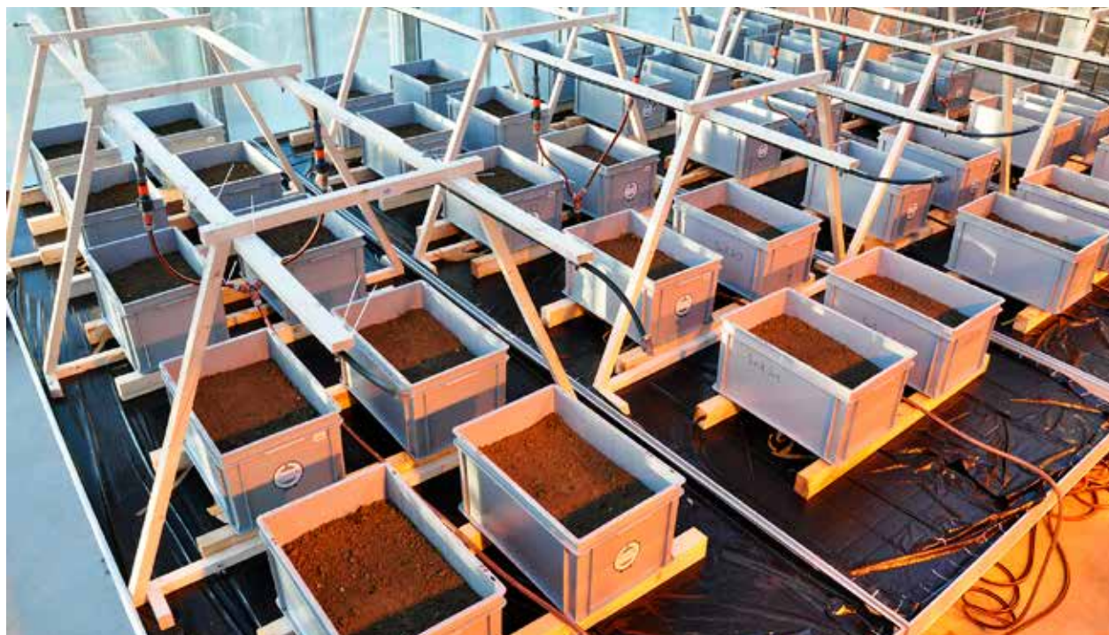
Figure 3 | Nouveaux essais d'incubation de films de paillage biodégradables dans la serre d'Agroscope sur le site de Reckenholz. Les matériaux sont incubés dans plusieurs sols prélevés sur les parcelles d'essai environnantes pendant plusieurs années et leurs résidus sont quantifiés périodiquement. Un mélange de prairie habituel sur le site est semé comme couverture végétale. (Photo: Franco Widmer, Agroscope)
